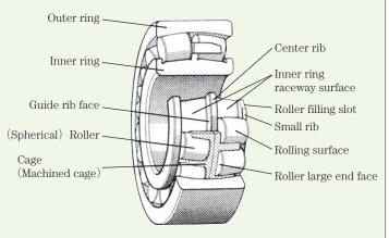
(d) Spherical roller bearing
